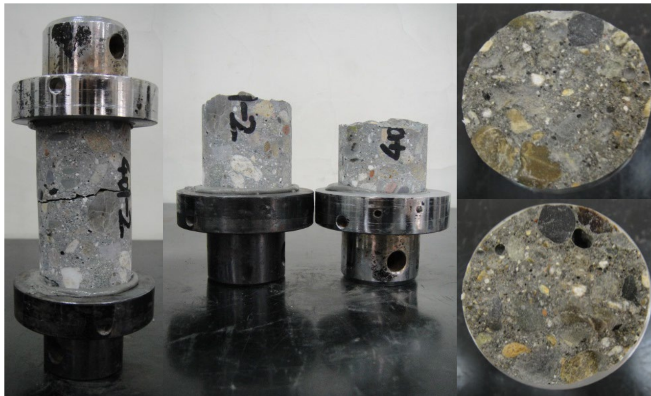
单轴拉伸试件破坏形态
